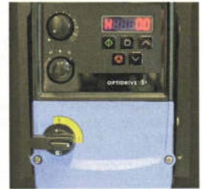
Abb. 8c Schalter 2 in Stellung >> (Vorwärts)
