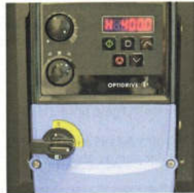
Abb. 8e Schalter 3 in maximaler Stellung 400 Hz
